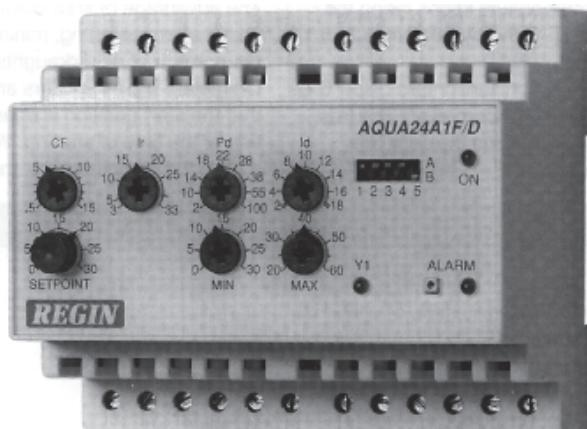
**AQUA24A1F/D** представляет собой П и ПИ регулятор, предназначенный для регулирования температуры воздуха в помещении или температуры приточного воздуха в системах отопления и вентиляции. Терморегулятор имеет малые размеры и предназначен для монтажа на DIN-рейке.
